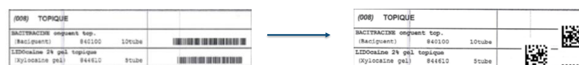
Fig 5. Utilisation de la reconnaissance optique de caractères pour identifier les médicaments sur un formulaire de commandes où un code à barres est corrompu et non-lisible, afin de le remplacer automatiquement par un code facile à scanner et fiable pour une double-vérification électronique
