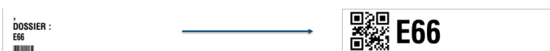
Fig 1. Modification des étiquettes de chambre. Le modèle initial (à gauche) présente un code à barre difficile à scanner et propice à se déformer. Un code QR est beaucoup plus résistant aux déformations, altérations et scans en angle. La chambre est aussi plus lisible
